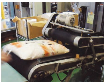
パッカーの静電気を除電、開封ミスやシールミスが解消します。
