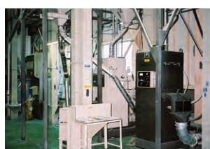
MDA除電設備の特定米穀精米機 山本製作所3連座精米機
