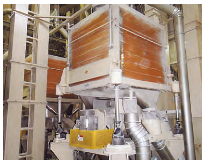
シフターの静電気帯電を除電。高効率の分離選別が容易になる。
