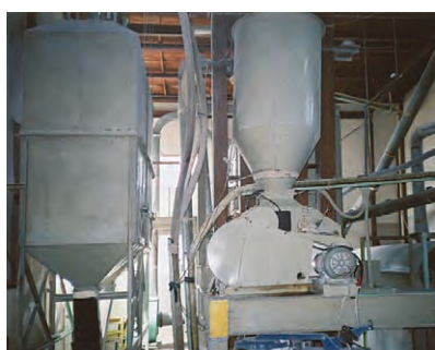
製粉機の静電気を除電。温度の上昇を抑えます。
