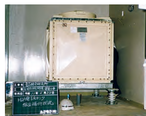
MDAマイナスイオン帯電水 連続イオン水製造装置
