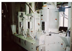
精米機・ラインの静電気を 除電 剥離性、糠切れの向上
