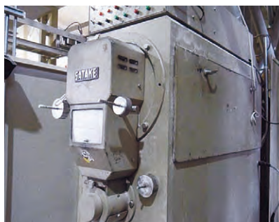
研米機の静電気を除電。流れをスムーズにします。
