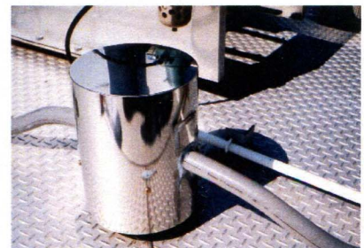
電極部雨よけカバー取り付け状況
