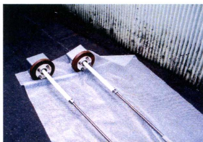
サイロ内部電子供給電極棒
