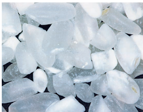
MDA精米設備のあと、ふるいを一番粗いものに取替える。糠切れの良い正粒が多く残っている。(石川県 ㈱米屋様精米の碎米)
