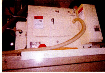
MDA精米機除電装置取り付け状況 (研削式精米機)
