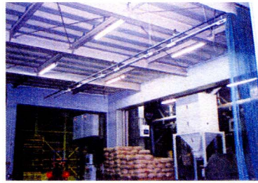
MDA電子シャワー空気浄化装置 (原料投入口)
