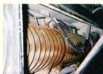
精麦機に設置した静電気除電電極板
