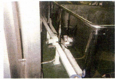
発酵中のパン生地に電子を供給しながら発酵させる電子供給バネ電極。(稼働中の状況)
