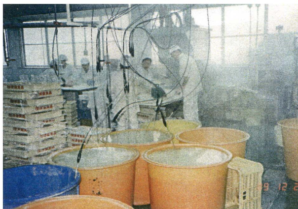
従来もち米の浸漬が15時間のところ2時間で浸漬が済むMDA浸漬装置
