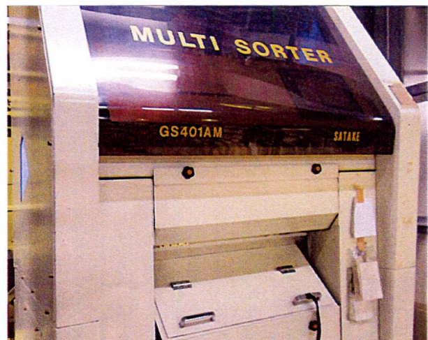
色彩選別機にMDA静電気除電装置を設備。色選の汚れや糠玉の付着が解消する。
