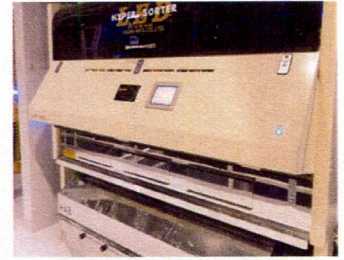
色彩選別機の静電気を除電、汚れ、糠玉の発生を抑えます。
