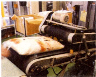
パッカーの静電気を除電、開封ミスやシールミスが解消します。
