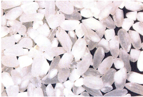
MDA精米の碎米、碎米が少ないので一番粗いふるい目に取り替える。正粒が多く残っている。 株式会社米屋様
