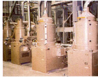
精米機の静電気を除電。流れをスムーズにします。
