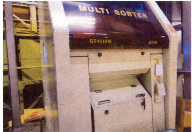
色彩選別機にMDA静電気除電装置を設備。 色彩選別の汚れや糠玉の付着が解消する。
