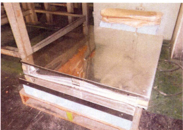
MDAパレット電極台 少ロットの30kgから500kgまでの玄米や 白米をこの上に乗せてパレットごとMDA 操作盤によってMDA処理ができます。
