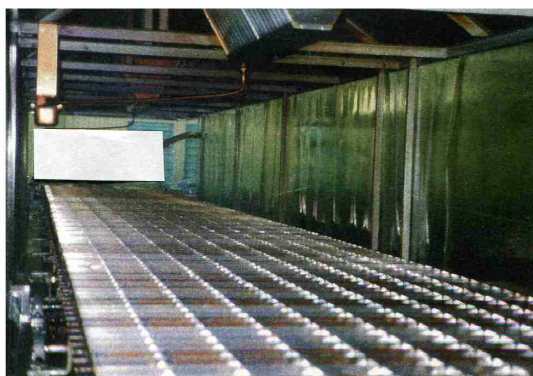
全長15m大型フライヤーで油揚げ中
