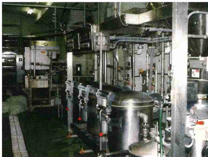
⑥この熱操作による大豆の蛋白質、脂質は熱湯中に抽出される。蛋白質は熱変性を受けて凝固しやすい豆乳に転化される。
