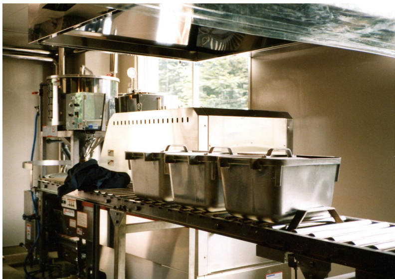
10 釜連続炊飯テストラインの釜コンベヤー据付状況 AiHO製自動連続炊飯ライン
