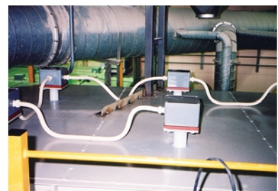
酒米タンク内の玄米に電極棒を介して電子を供給
