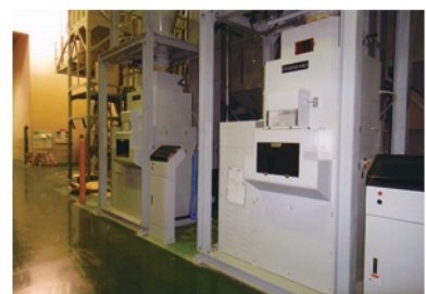
酒米機にMDA静電気除電装置を設備 (新中野工業30依精米機)
