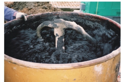
ミキサーの中に炭素を入れ水を加えてよく練る。
