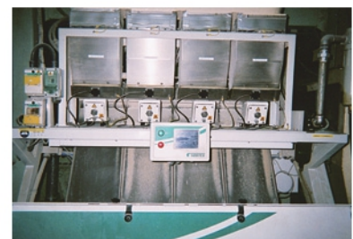
MDA静電気除電装置取り付け状況 (色彩選別機)
