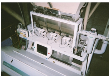
MDA静電気除電装置取り付け状況 (色彩選別機)
