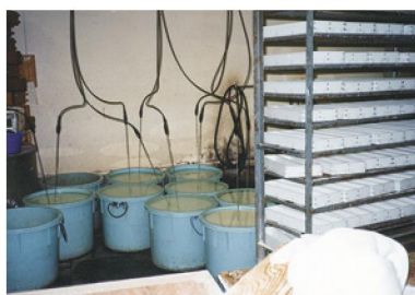
もち米浸漬桶にMDA電極を差し、 浸漬を促進させる。通常15時間を要 する浸漬を1時間で完了する。
