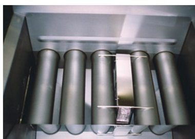
フライヤー内MDA電極設置状況
