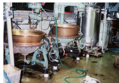
煮釜にMDA電極を設置して利用。
