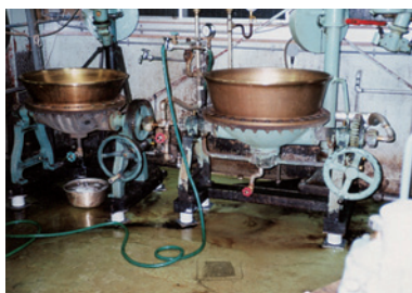
煮釜にMDA電極を設置して利用。
