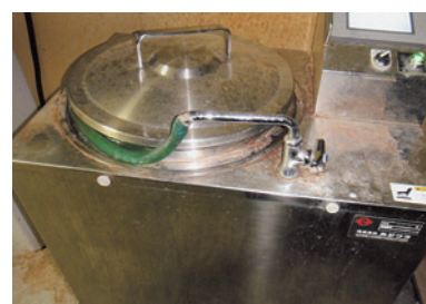
自動製あん機(カジワラ製)にMDA電極を設置して利用。
