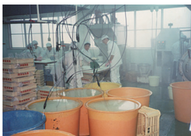
もち米浸漬桶にMDA電極を差し、 浸漬を促進させる。通常15時間要 する浸漬を1時間で完了する。
