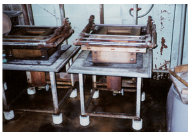
蒸し器にMDA電極を設置して利用。
