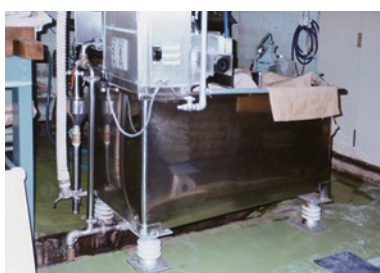
製あんプラントにMDA電極を設置して利用。
