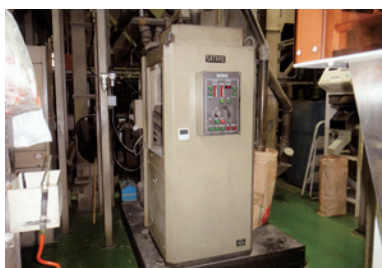
MDA精米機除電装置取り付け状況 (もち米精米機) 50馬力
