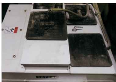
MDA精米機除電装置取り付け状況 (摩擦式精米機)
