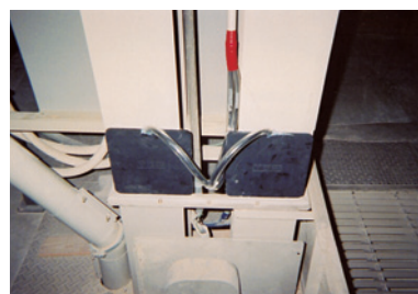
MDA除電電極板取り付け状況 (昇穀機)
