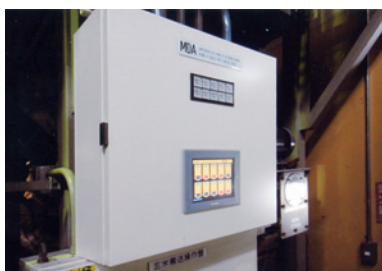
うるち玄米タンクMDAエージング タイム操作盤
