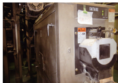
MDA精米機除電装置取り付け状況 サタケミルモア25馬力精米機
