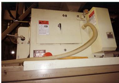
MDA精米機除電装置取り付け状況
