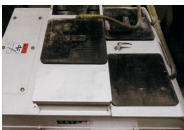
MDA精米機除電装置取り付け状況
