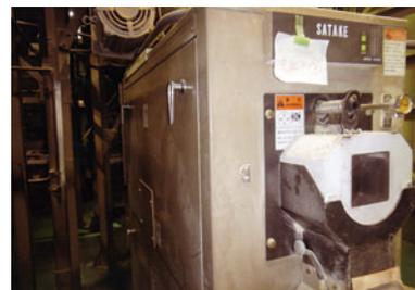
MDA精米機除電装置取り付け状況
