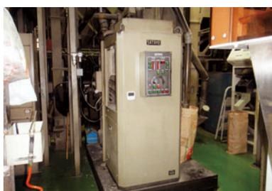
MDA精米機除電装置取り付け状況
