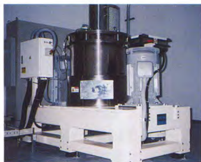
粉碎機の静電気を除電。温度の上昇を抑えます。
