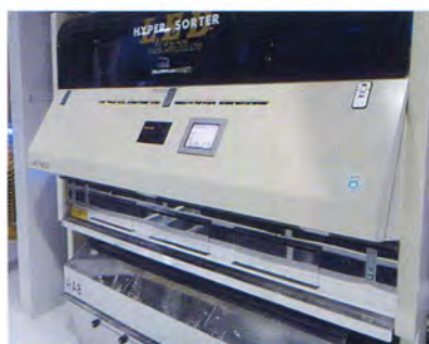
色彩選別機の静電気を除電、本体の汚れ、糠玉の付着を抑えます。
