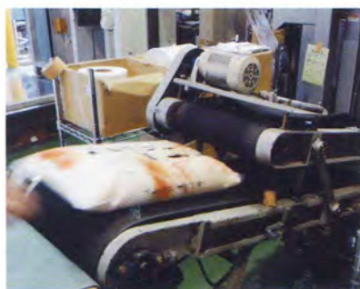
パッカーの静電気を除電、開封ミスやシールミスが解消します。
