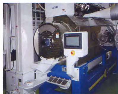
無洗米機の静電気を除電。流れをスムーズにします。
