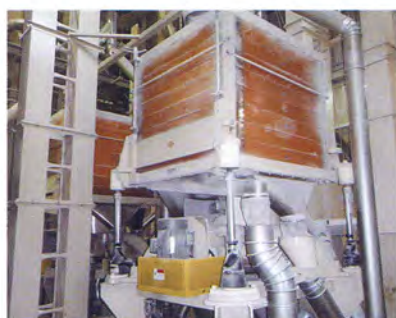
シフターの静電気帯電を除電。高効率の分離選別が容易になる。
