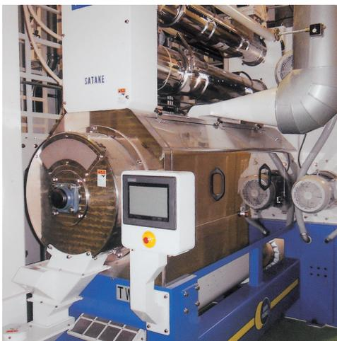
無洗米機TWR加工装置MDA除電装置設置状況
